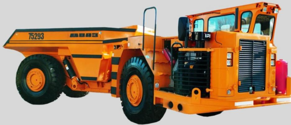
Предназначен для транспортирования и самосвальной разгрузки горной массы и полезных ископаемых в подземных условиях не опасных по пыли и газу, а также вне автомобильных дорог общего пользования в условиях открытой добычи.
