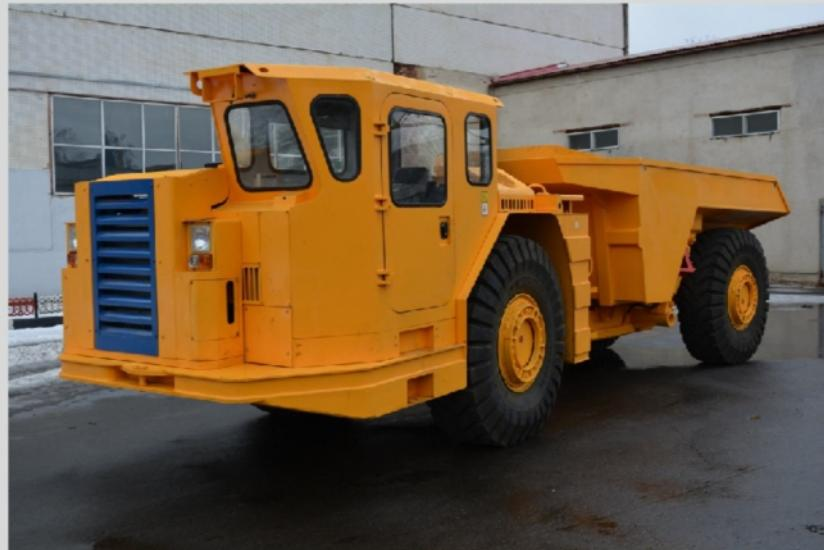
Предназначен для транспортирования и самосвальной разгрузки горной массы и полезных ископаемых в подземных условиях не опасных по пыли и газу, а также вне автомобильных дорог общего пользования в условиях открытой добычи. Продольный профиль дороги может иметь подъемы до 10°, кратковременные подъемы – до 15° при длине до 200 м.
