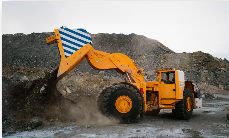
Предназначена для погрузочно-доставочных работ с взорванными или разрыхленными механическим способом породами в стесненных условиях подземных шахт и проходах, не опасных по пыли и газу, а также – в условиях открытой добычи полезных ископаемых, строительстве тоннелей и др.
