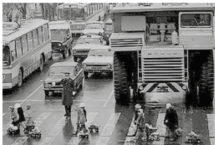
Самосвал грузоподъемностью 75 тонн
